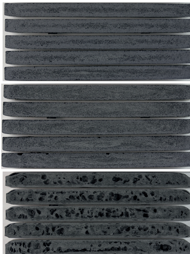
Bild 5. Durch die Werkzeugtemperatur und die Nachdruckdauer lässt sich die Schaumstruktur des Bauteils einstellen. Je nach gewählten Parametern unterscheidet sich die Struktur deutlich. Gut zu sehen ist das bei den abgebildeten aufgesägten Probestücken (oben: 155 °C Werkzeugtemperatur und 11 s Nachdruckdauer; Mitte: 155 °C Werkzeugtemperatur und 7 s Nachdruckdauer; unten: 185 °C Werkzeugtemperatur und 11 s Nachdruckdauer
